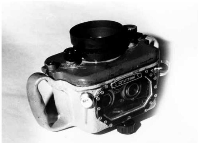
Стереoaппарат «Спутник» в боксе
